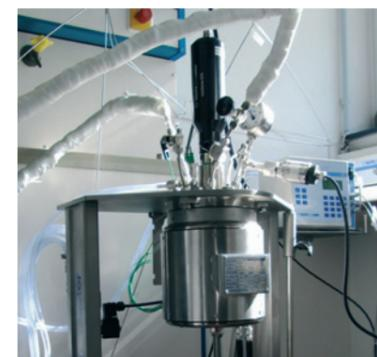
Abb. 2: Versuchsaufbau zur Dreiphasenmethanisierung im Rührkesselreaktor bzw. Autoklaven
