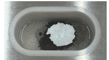
Abbildung 1: Mahlgut und Mahlkugeln vor dem Vermahlen
